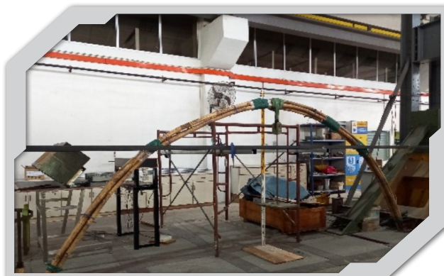
Pengujian kekuatan struktur Buluh
